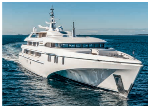
Sparsam: Die 20 Meter breite „White Rabbit“ verbraucht bei zwölf Knoten nur 440 Liter/Stunde.
